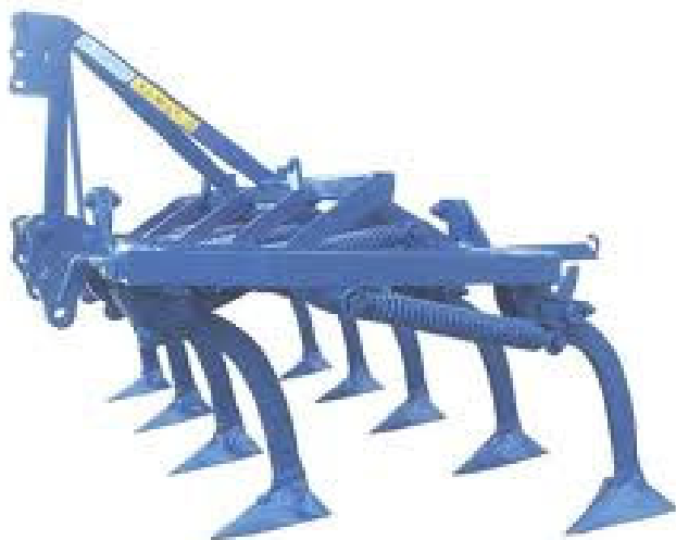
Figura 11 - Coltivatori ed estirpatori trovano nella semplicità costruttiva e praticità d'impiego le ragioni del loro apprezzamento per gli interventi di gestione degli interfilari nei primi anni d'impianto.
