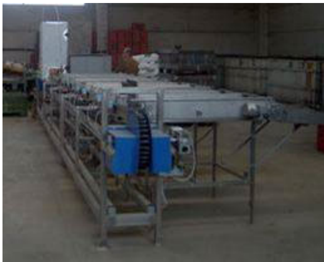
Figura 3 - Panoramica della macchina per la selezione ottica delle talee. In primo piano le vasche di raccolta delle talee in funzione della classe di diametro.
