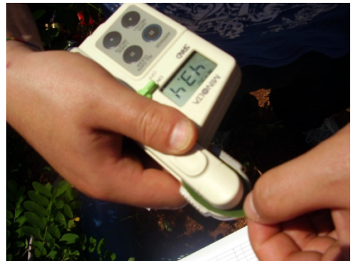
Foto 6b - Misuratore (Minolta SPAD-502) del contenuto relativo di clorofilla (SPAD).
