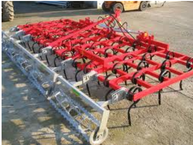
Figura 7 - L'erpatura con operatrice ad elementi elastici trova maggior possibilità d'impiego nelle operazioni pre-impianto invernali e primaverili.
