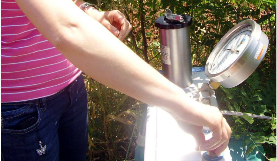
Foto 5 - Misura del potenziale idrico con camera di pressione tipo Scholander.
