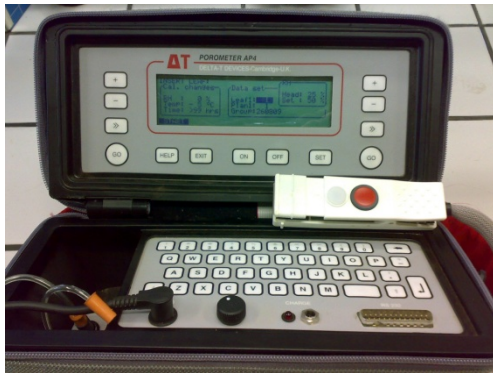
Foto 6a - Porometro a diffusione (Delta-T AP4) per misurare la conduttanza.
