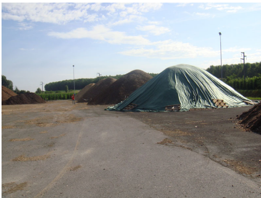
Figura 1 - Allestimento delle prove per la comparazione dell'effetto della copertura in cumuli di cippato di pioppo sottoposti ad essiccazione naturale.
