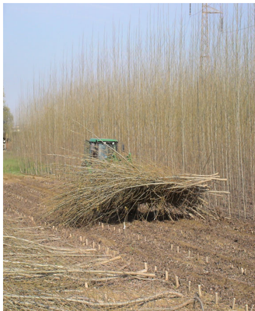
Figura 5 - Macchina per l'accumulo della biomassa a bordo campo.
