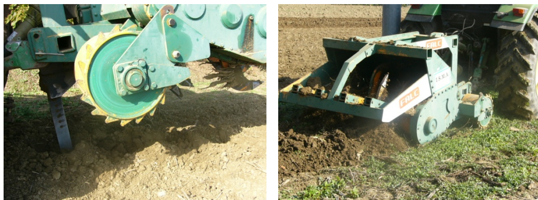
Figura 1 - Prototipo Falc/Cra-Ing: apparato rotativo e lama per la pre-fessurazione profonda (sinistra); il prototipo al lavoro (destra).
