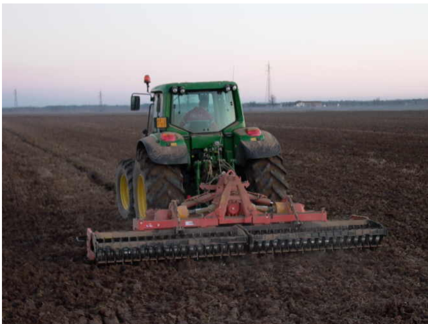
Figura 6 - L'erpatura con operatrice azionata dalla presa di potenza rappresenta una delle operazioni di lavorazione secondaria di maggior versatilità.
