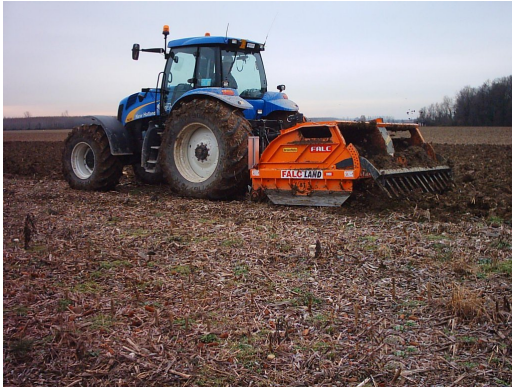
Figura 4 - La rotoaratura rappresenta un'operazione di lavorazione principale eseguita in particolari condizioni operative.
