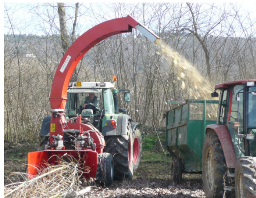
Figura 8 - Falciatrici-caricatrice Spapperi mod. RT equipaggiata con testata pick up.
