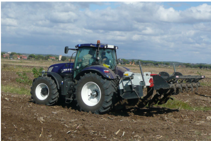
Figura 2 - La discissura trova una favorevole applicazione insieme all'aratura superficiale per effettuare la lavorazione a doppio strato.
