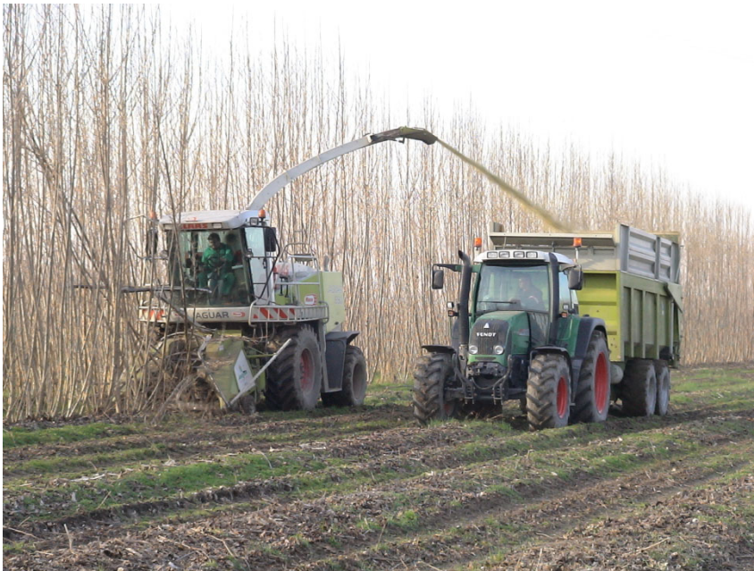
Figura 1- Falciatrinciacaricatrice Claas Jaguar in raccolta di pioppo.
