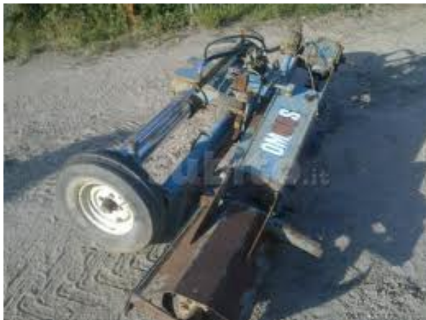
Figura 10 - Le zappatrici rotative con elemento traslante per la gestione degli interceppi trovano frequenti limiti nella distanza d'impianto dell'arboreto lungo la fila.
