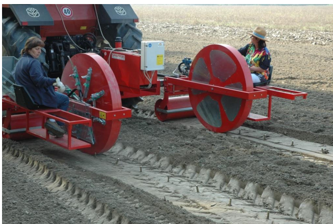
Figura 4 - Operazione di impianto di talee di pioppo.
