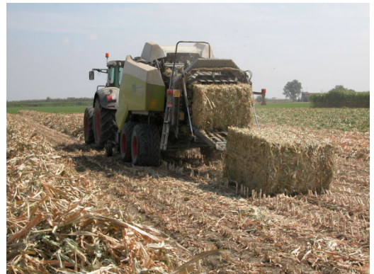
Foto 3 a,b - Fasi di raccolta del sorgo da biomassa per termo-conversione: sfalcio con falcia-condizionatrice (a sinistra) e pressatura della biomassa dopo l'essiccazione (a destra).
