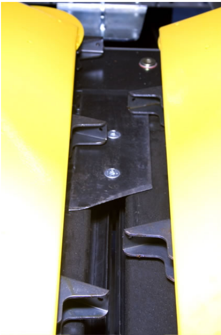
Figura 4 - L'installazione di sistemi di taglio fissi o rotanti consente di aumentare la versatilità delle testate da mais consentendone l'impiego anche su girasole.
