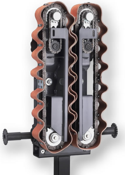
Figura 7 - L'adozione di sistemi di presa a nastro consentono una buona tenuta dello stelo reciso.
