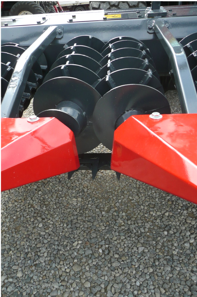
Foto 2 - Particolare del gruppo di condizionamento a coclee.
