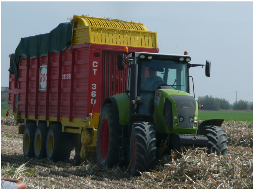
Foto 4 - Carro auto caricante per la raccolta del prodotto sfuso.
