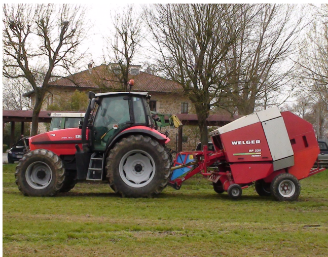
Foto 3 - Rotoimballatrice RP 320 Farmer della Welger a camera fissa.
