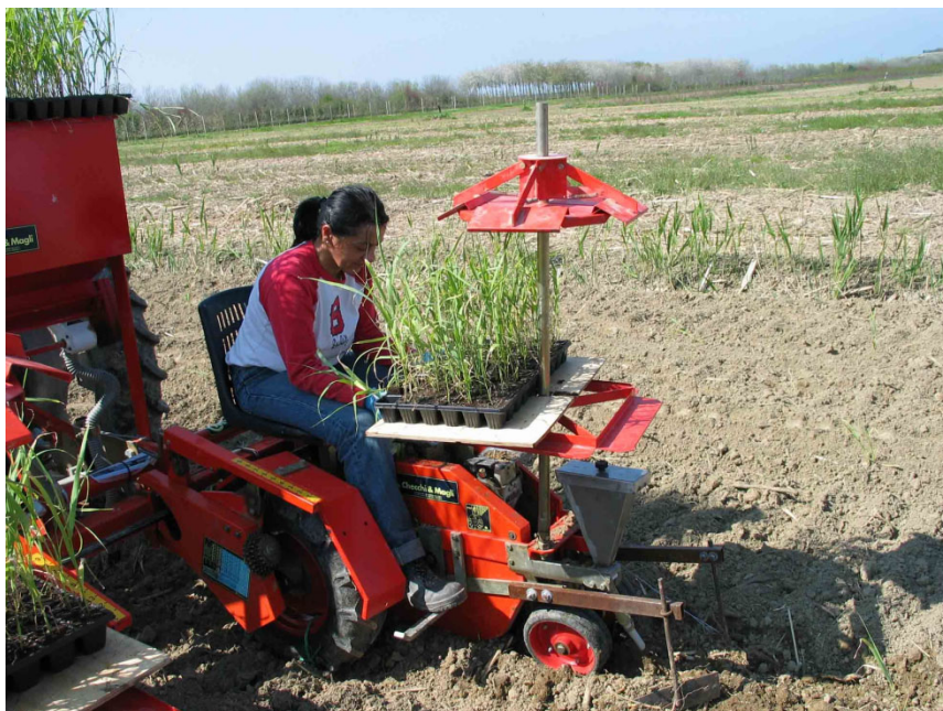
Foto 2 - Trapianto meccanico di piantine di Arundo micro-propagate.
