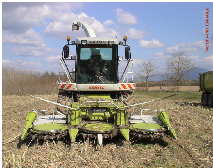
Foto 1 - Falcia trincia caricatrice Claas Jaguar 850 equipaggiata con testata di serie Claas RU 450 XTRA.
