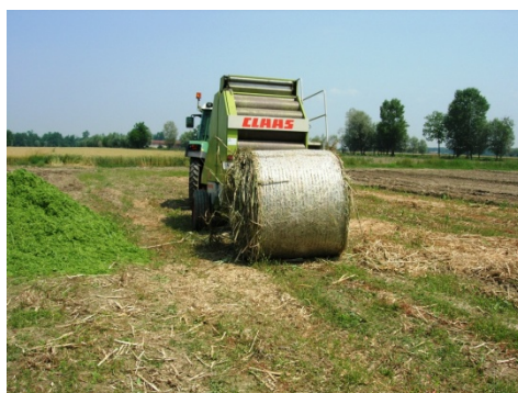
Figura 2 - Modalità di raccolta della canna comune, trinciatura pianta verde e imballatura pianta essiccata.
