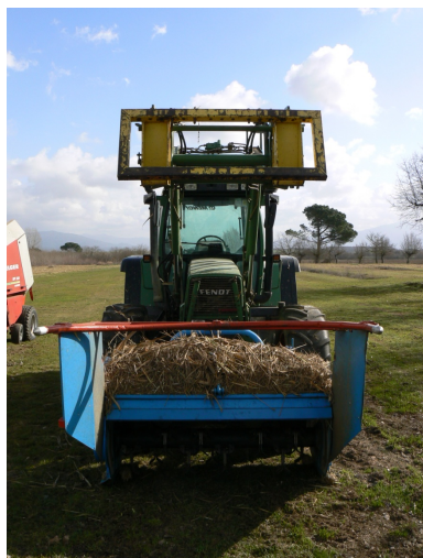
Foto 2 - Prototipo per la trinciatura delle colture erbacee da biomassa BNU 160 AD della Nobili.
