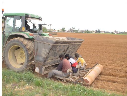
Foto 4 - Trapiantatrice in lavoro su tre file distanziate a 75 cm.
