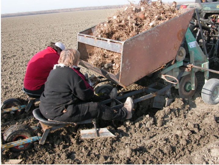
Foto 5 - Trapianto meccanico di rizomi di Arundo , Conselice (RA), 2007.
