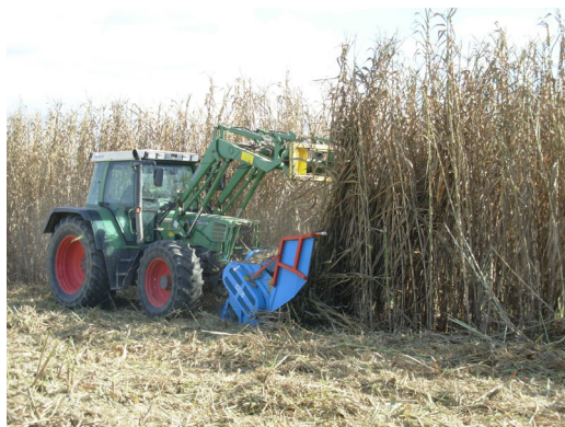
Foto 8 - Trinciante Nobili BNU 160 AD in fase di raccolta.
