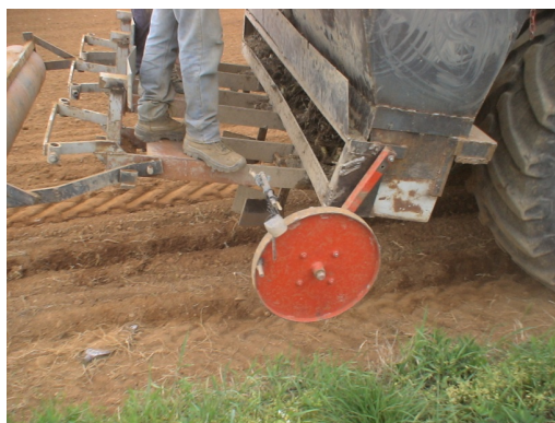
Foto 5 - Particolare della ruota di frizione azionante l'avvisatore acustico per il posizionamento dei rizomi alla distanza impostata.
