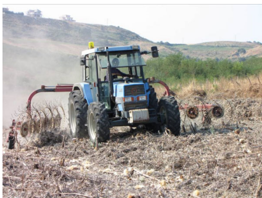
Figura 4 - Ranghinatore SLAM GR 300 in fase di lavoro.
