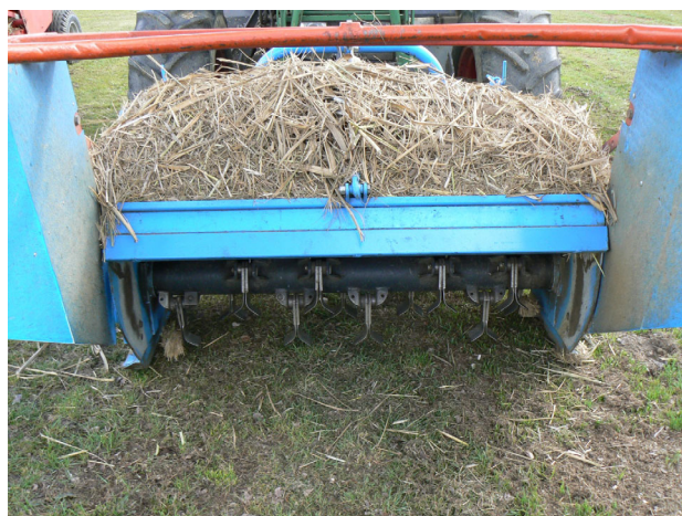
Foto 4 - Particolare dell'organo trinciante della Nobili BNU 160 AD.
