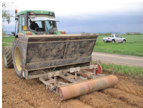
Foto 1 - Vista posteriore della trapiantatrice.
