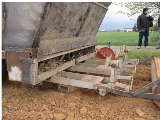
Foto 3 - Particolare della fessura di presa dei rizomi e degli assolcatori.
