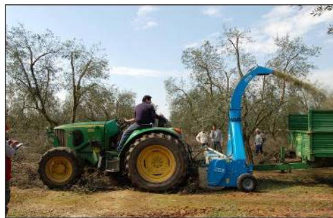
Foto 5 - Macchina priva di proprio dispositivo di carico.
