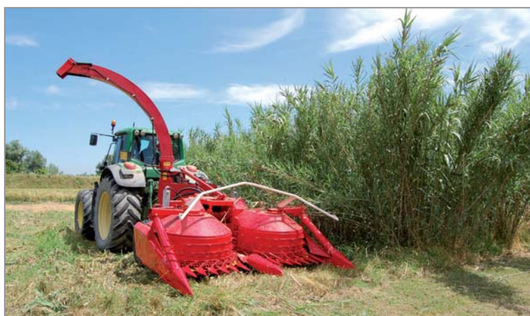
Foto 1 - Prototipo di falciatrice-caricatrice per la produzione di “pezzotti” di canna.
