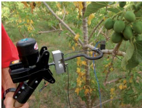
Foto 6 - Abbacchiatore elettrico modificato dal CRA-ING, utilizzato nei test preliminari di raccolta agevolata.
