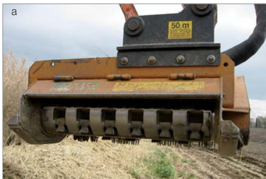
Foto 3 - Trinciatore forestale a martelli (a) e trinciatore a coltelli (b) a confronto
