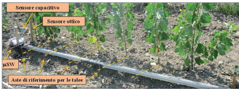
Foto 2 - Disposizione della struttura di prova lungo la fila. Nella figura vengono messi in evidenza i sensori e le aste di riferimento posizionate in corrispondenza delle talee di pioppo. \mu SW = leva del microinterruttore.
