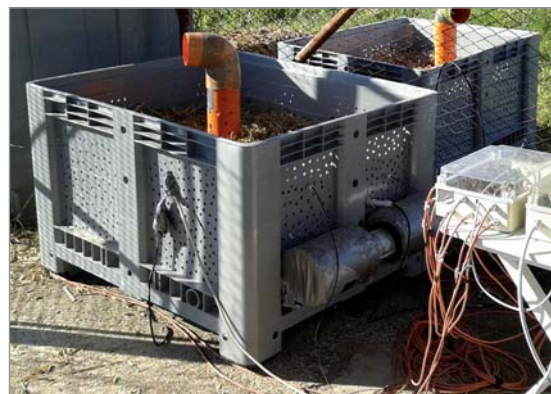
Foto 3 - Bin in cui è stata prevista la ventilazione forzata con dettaglio dell'equipaggiamento dei motori (tesi 3).
