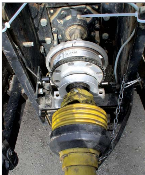
Foto 2 - Torsio-tachimetro installato sulla p.d.p. del trattore.
