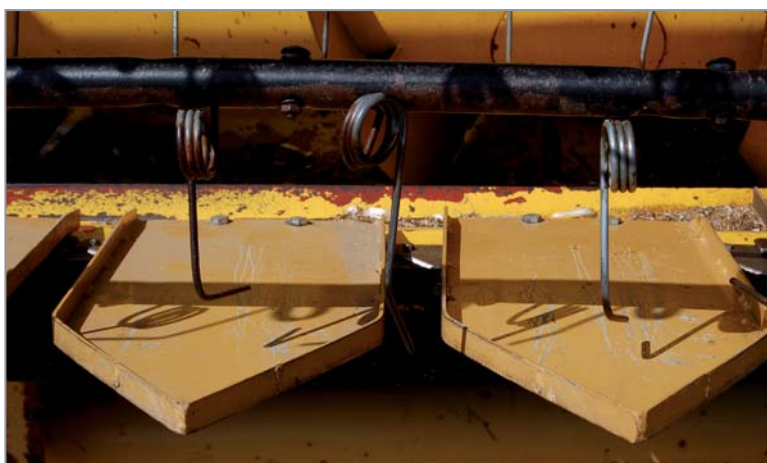
Foto 1 - Particolare piastre metalliche del dispositivo di modifica della testata da frumento.
