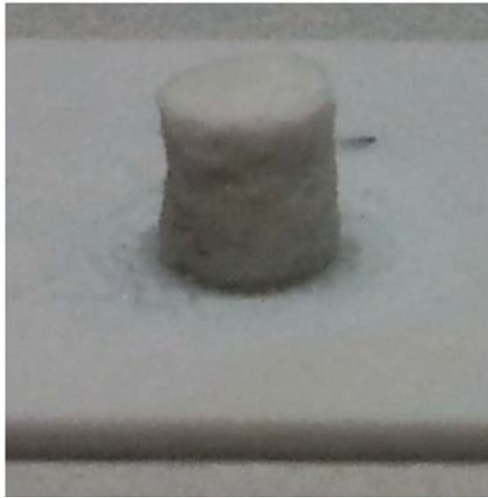
Foto 2 - Profilo del provino di cenere del legno di jatropha a 1.600°C.
