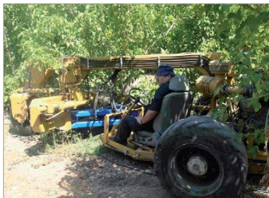
Foto 2 - Scuotitore meccanico della Dotan Technologies per la raccolta selettiva del seme di jatropha (fonte: www.dotantech.com/htmls/page_627.aspx?c0=13285&bsp=13035&bss53=13035 )
