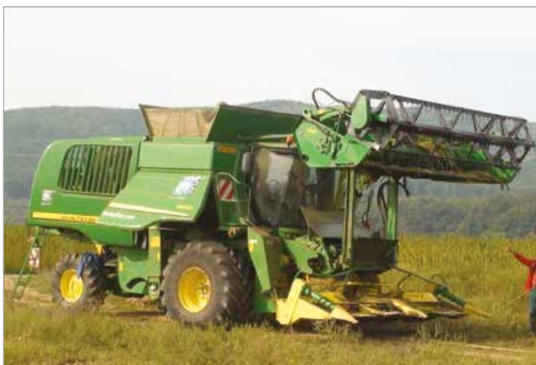
Foto 5 - Vista laterale della mietitrebbia abbinata alla testata tipo kemper e testata da grano © Luigi Parl.
