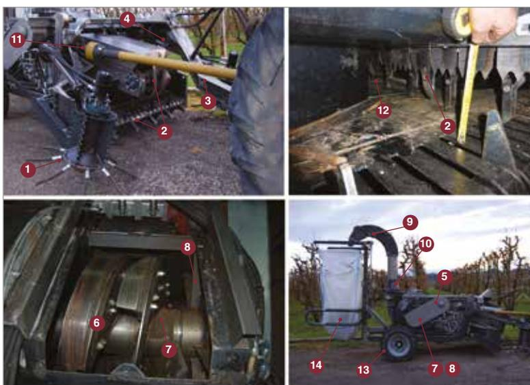
**Foto 1** - 1) Rulli andanatori (opzionale); 2) rullo e catena di raccolta; 3) timone per il traino anteriore; 4) cilindro di regolazione dell'altezza di raccolta; 5) scambiatore olio idraulico con ventola elettrica; 6) coclea cippatrice con coltelli elicoidali; 7) albero coclea cippatrice; 8) ventola lanciatriatrice; 9) tubo lanciatore con terminale orientabile; 10) ralla tubo lanciatore; 11) presa di forza; 12) rulli alimentatori; 13) pneumatici; 14) accessorio posteriore (opzionale).
