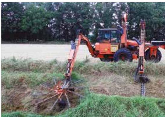
**Foto 4** - Sfalcio e immediato trasporto della vegetazione sul piano della sponda con nastro trasportatore o ranghinatore rotativo (fonte: [www.berky.de](http://www.berky.de)).
