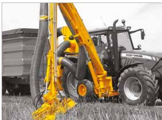
**Foto 5** - Modello "Grenadier" della ditta olandese Herder, con particolare della testata trinciante (fonte: [www.herder.nl](http://www.herder.nl)).
