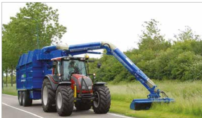
Foto 2 - Trincia-aspiranti della ditta Hemos durante le operazioni di sfalcio dell'erba, (fonte: [www.hemos.nl](http://www.hemos.nl)).
