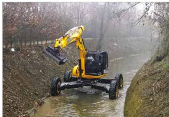
**Foto 8** - L'escavatore a ragno Batemag P.100 della Osma, a 2 o 4 ruote motrici (fonte: [www.batemag.com](http://www.batemag.com)).
