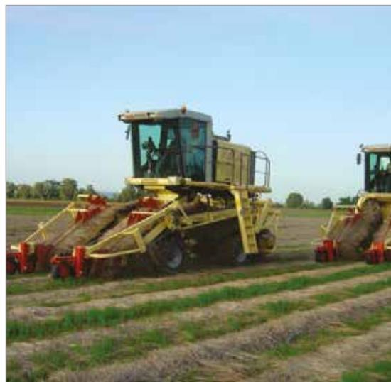
Foto 3 - Macchina semovente "volta-andana" in azione © Dehondt.
