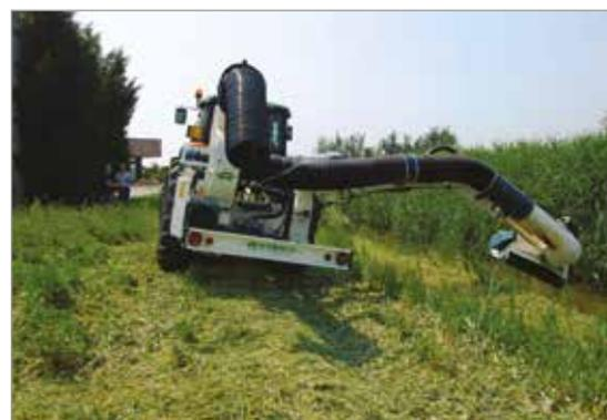
**Foto 9** - La macchina in fase operativa con il prodotto trinciato che può essere disposto in andana sul piano orizzontale della sponda oppure convogliato direttamente in un cassone trainato (fonte: CREA-ING [www.hymach.it](http://www.hymach.it)).
