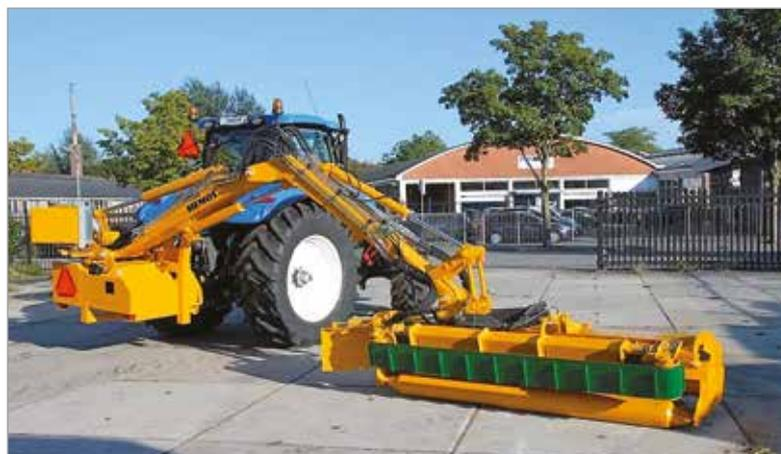
Foto 3 - Trinciasarmenti con nastro trasportatore della ditta Hemos (fonte: [www.hemos.nl](http://www.hemos.nl)).
