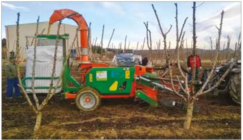
Foto 3 - Macchina in fase di lavoro - Configurazione con big-bag.
