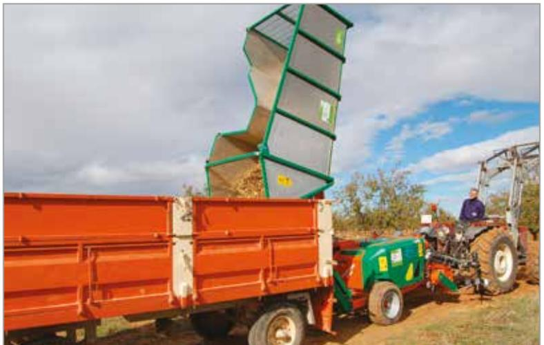
Foto 4 - Macchina in fase di scarico del materiale cippato - Configurazione con cassone.
