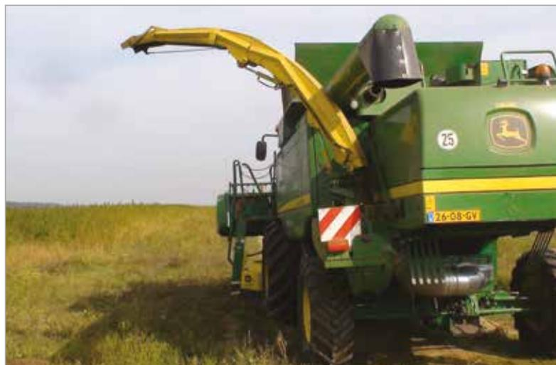
Foto 4 - Sistema di raccolta dei residui di trebbiatura.
