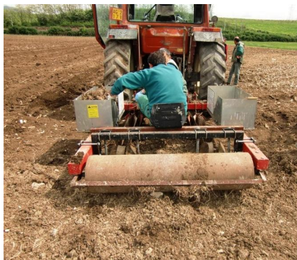
Messa a dimora di rizomi di canna e miscanto con un prototipo sperimentale di trapiantatrice.
