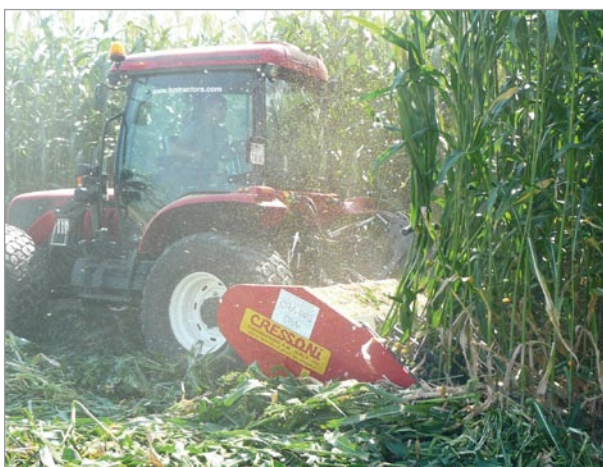
Foto 1 - Nuovo prototipo CRA-ING/Cressoni in lavoro su sorgo da fibra.
