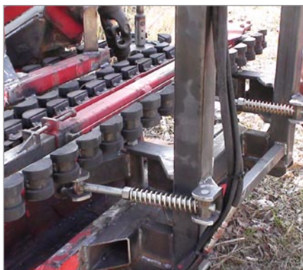
Foto 3 - Dispositivo di trasporto inferiore: sono visibili i braccetti snodati con molle a variabile resistenza a compressione.
