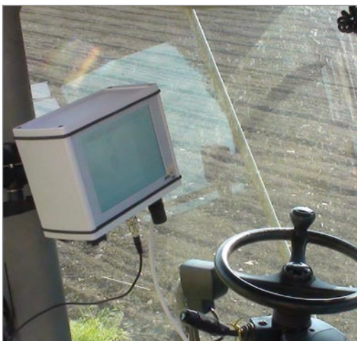
Foto 1 - PC veicolare installato nella cabina di guida della falciatrinciacaricatrice Claas Jaguar 890.
