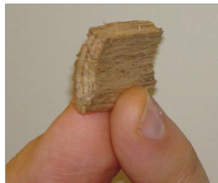
Foto 4 - Sezione trasversale di un chips di roverella prodotto dal rotore CRA-ING.
