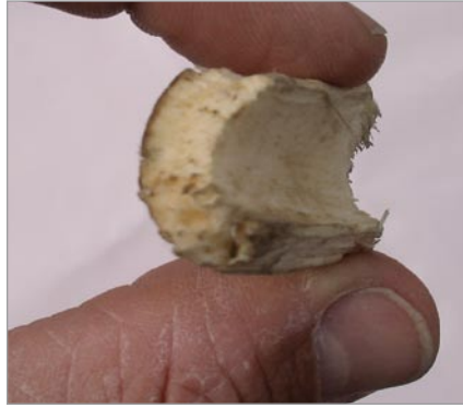
Foto 2 - Sezione trasversale di un chips di pioppo prodotto dal rotore CRA-ING.
