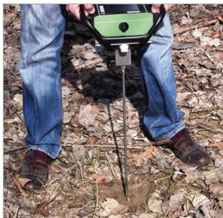
Foto 2 - Penetramento elettronico (Cone Index).
