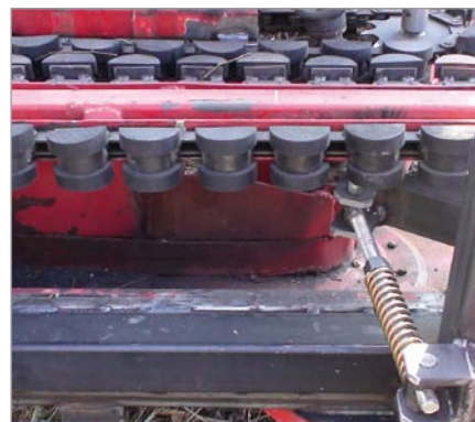
Foto 4 - Particolare dei tasselli gommati montati sulle catene di trasporto.
