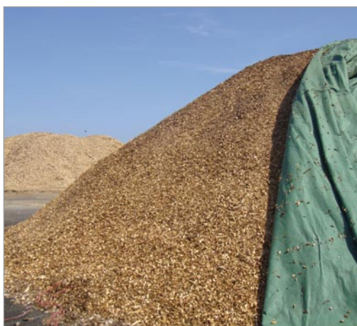
Foto 1 - Copertura del cumulo con telo geotessile.
