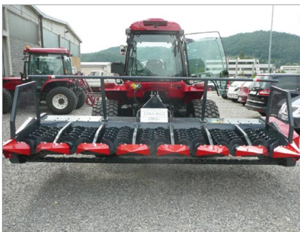
Foto 1 - Prototipo di falciaccondizionatrice realizzato da CRA-ING.
