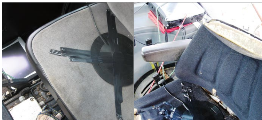
Foto 2 - Strumentazione utilizzata durante i rilievi di vibrazioni. A sinistra trattore LANDINI modificata (Tesi 1), a destra trattore NEW HOLLAND (Tesi 2).
