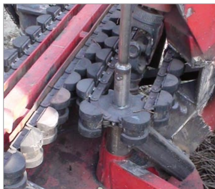
Foto 2 - Sistema di trasporto a catene gommate controrotanti.
