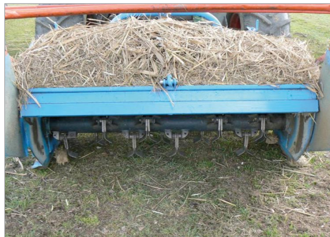
Foto 3 - Particolare dell'organo trinciante della Nobili.
