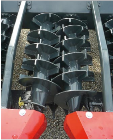
Foto 2 - Particolare del gruppo di condizionamento a coclee.
