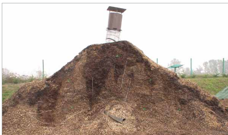
Foto 2 - Sezione cumulo ventilato.
