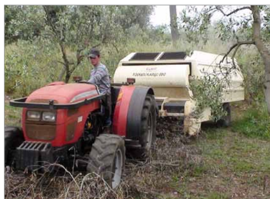
Foto 3 - Trinciasarmenti in fase di lavoro. È possibile apprezzare la presenza del cassone di carico posteriore.
